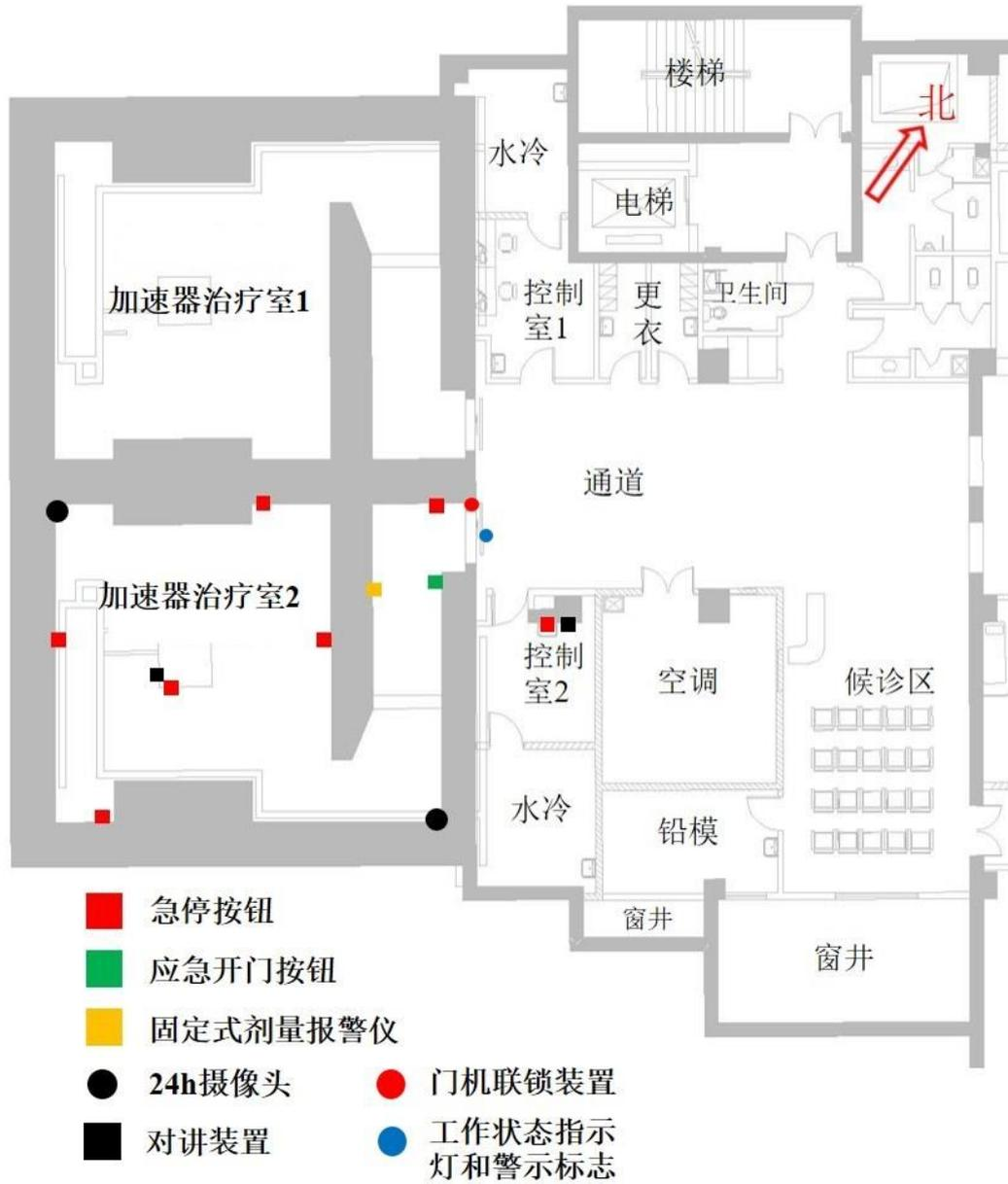
附图四 加速器治疗室2平面图及辐射安全与防护设施分布图
